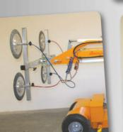
Le circuit de vide est divisé en deux boucles pour plus de sécurité. Voici les deux boucles avec des flexibles respectivement bleus et rouges.
